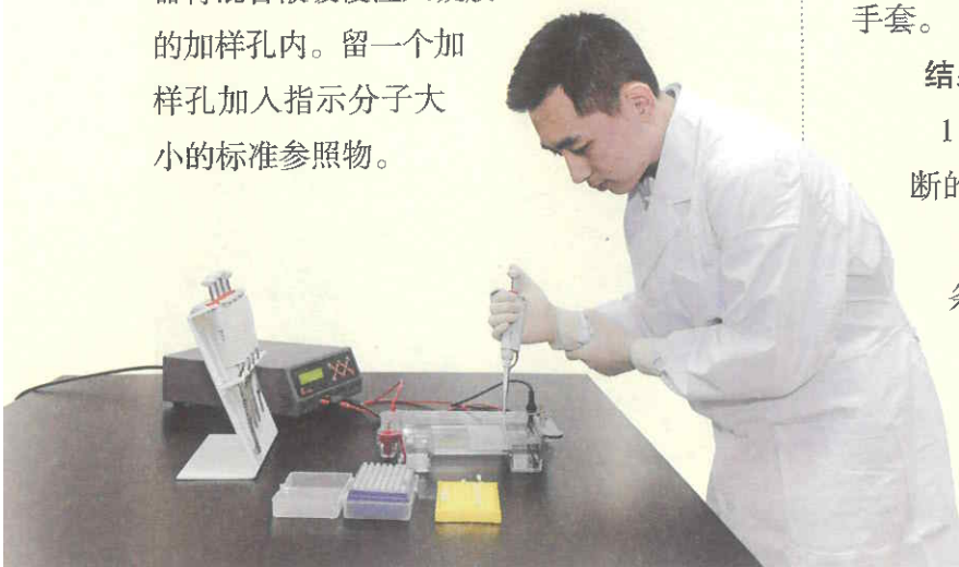
往凝胶加样孔内加样的操作
